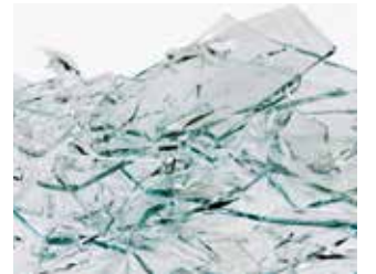
Gewöhnliches Fensterglas zersplittert und der Weg durch das Fenster ist frei.
