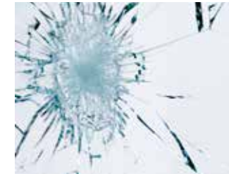
Das Verbund-Sicherheitsglas bricht trotz Gewalteinwirkung nicht auseinander.
